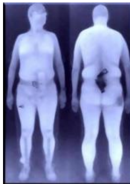
Figura 1: Retrô espalhamento: escaneamento apenas por baixo da roupa, identificação de arma de fogo [8]
